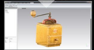
Surowy wynik skanowania na stoliku obrotowym - chmura punktów
